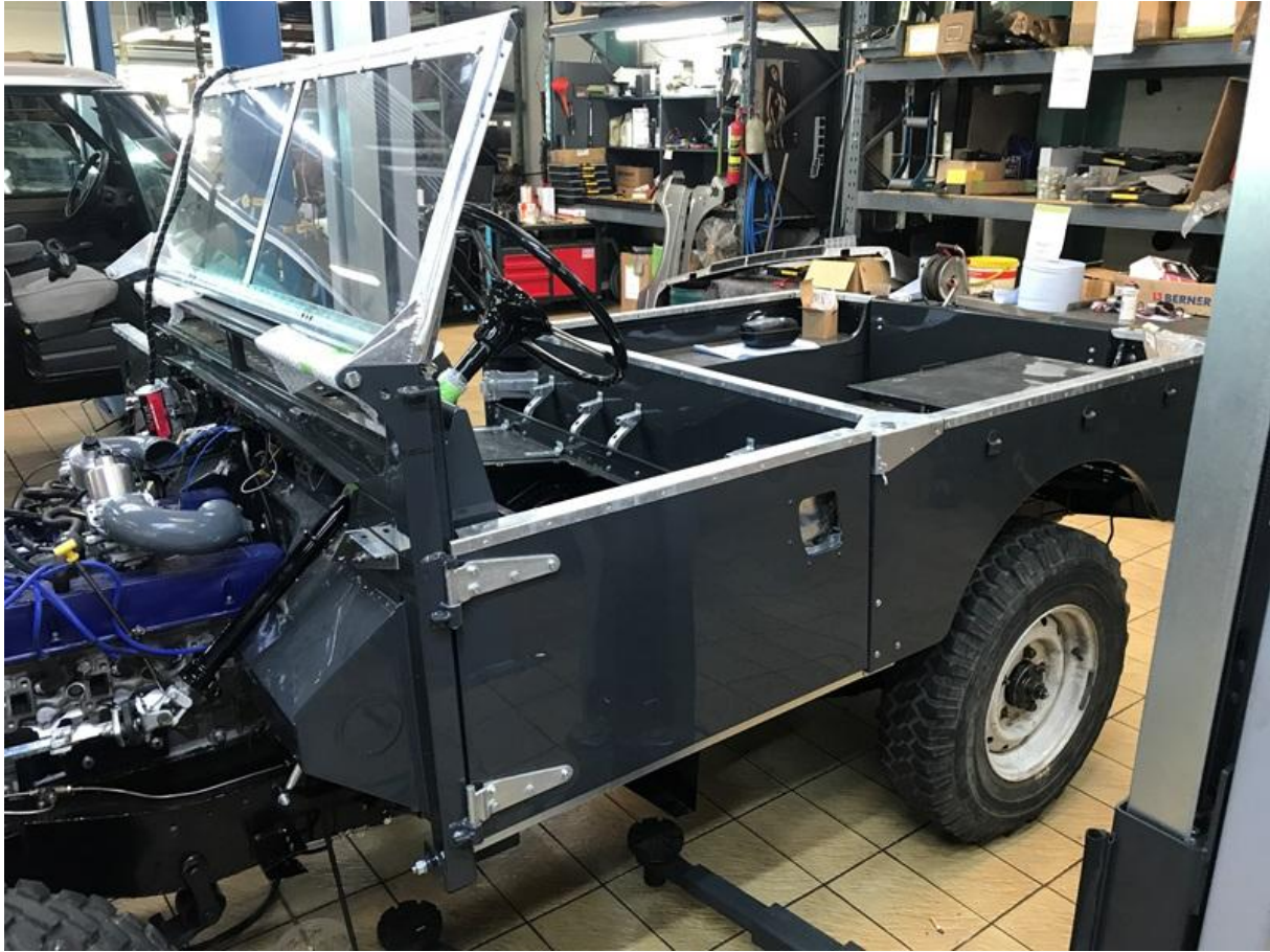
Jetzt wird der Sitzkasten eingebaut.
