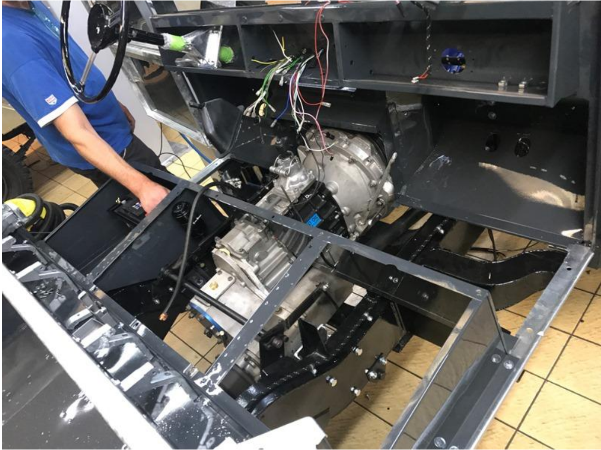
Im Sitzkasten wird noch eine Standheizung untergebracht.
